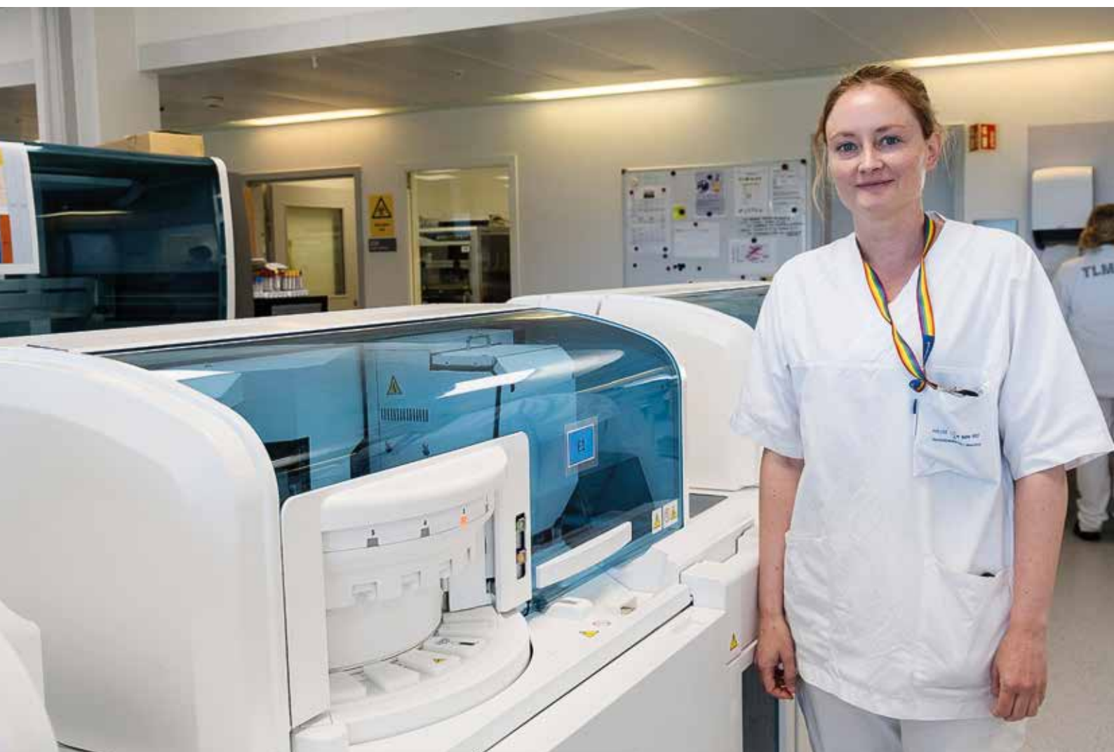
Fagbioingeniør Hege Kristin Hermansen greier ut om elektrokjemiluminescens-immunoassay, også kalt ECLIA, som er sandwich-metoden cobas Pro bruker når PSA analyseres. Etter 18 minutter er svaret klart.
